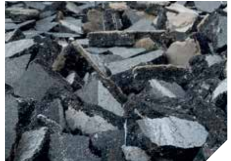
Asfalt geri dönüşümü
